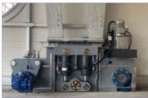
Ansicht Fahrschemel ©Unger Stahlbau Ges.m.b.H..jpg
